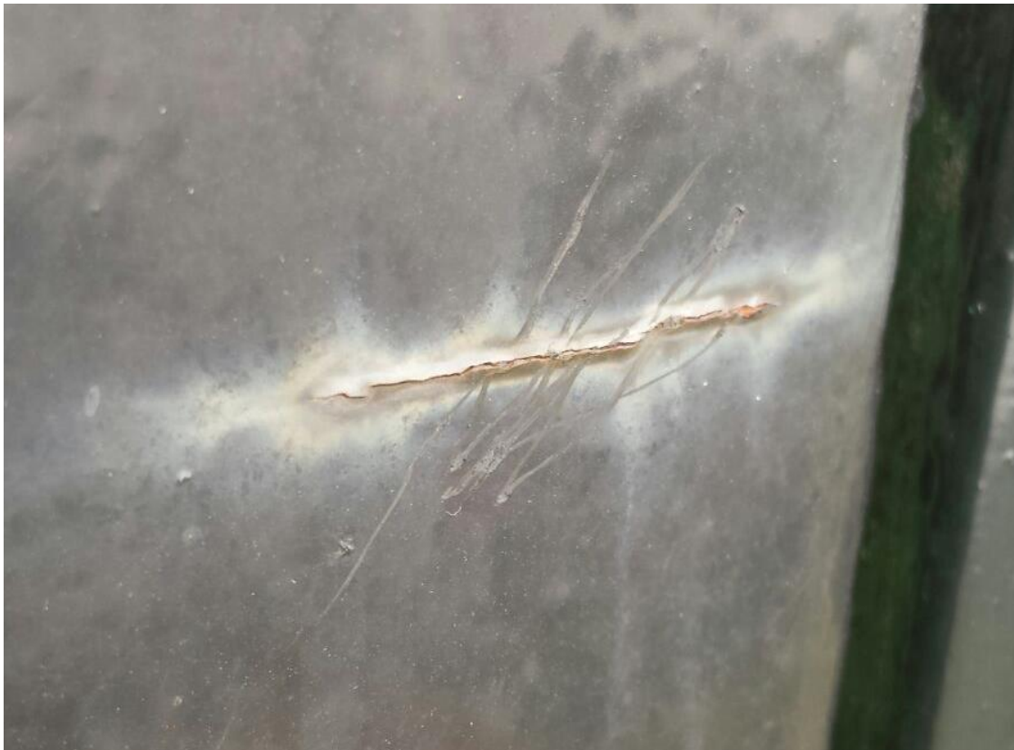
Foto 11: Scheur in de roede voor het schoonmaken, foto afkomstig van J. Kooistra.
