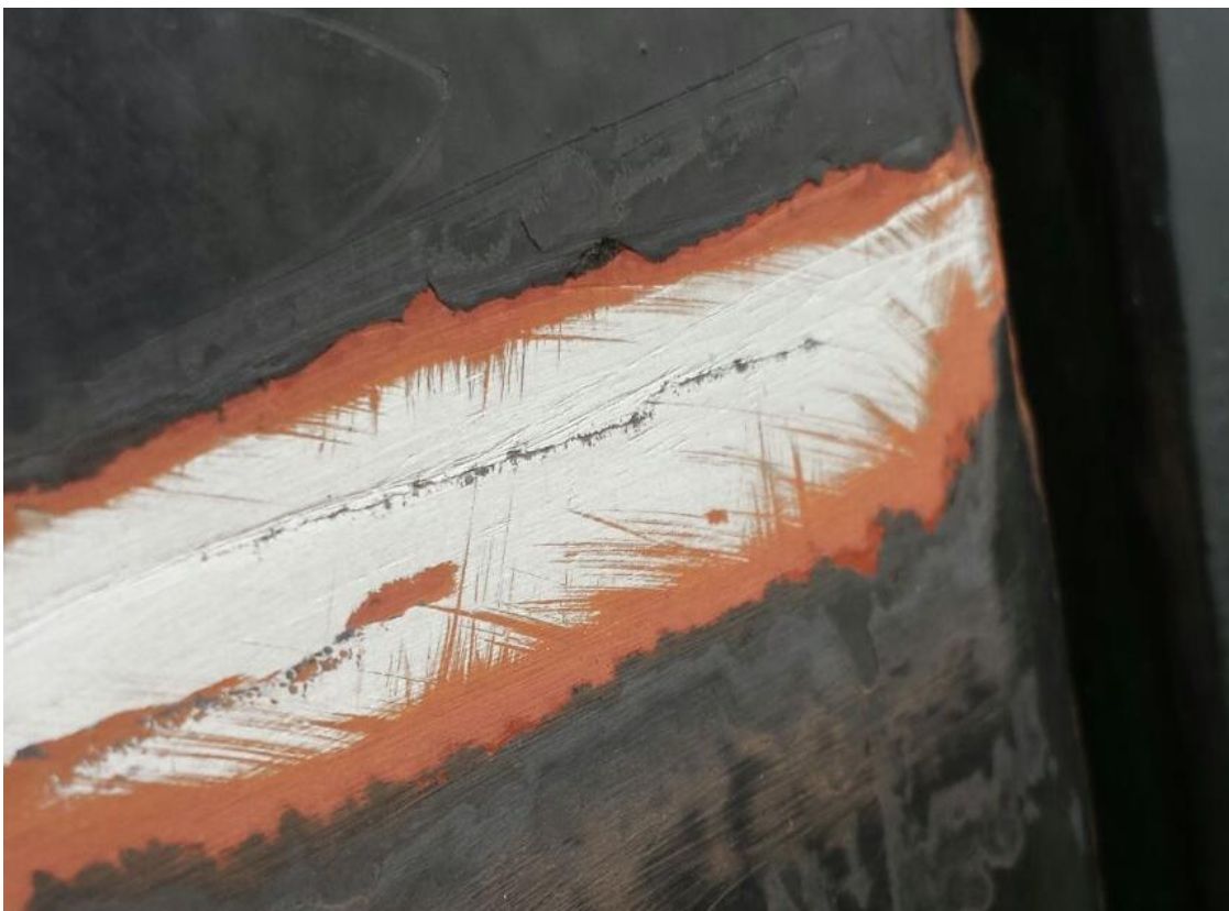
Foto 12: Scheur in de roede na het schoonmaken, foto afkomstig van J. Kooistra.
